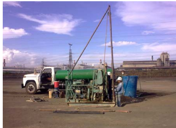
Fotografía N° 1 Ejecución del ensayo SPT (Perforación P1)
